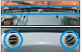
エアコン吹き出し口&デフロスタ
