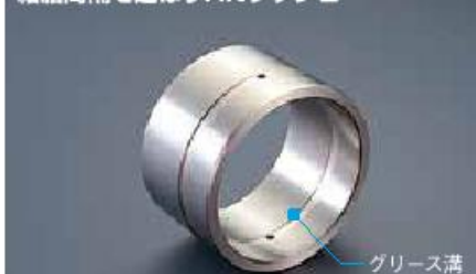
作業機ジョイント部に潤滑特性に優れたHNブッシュを採用し給脂間隔を250時間としました。 <注>稼働開始から 50 時間までの給脂間隔は取扱説明書に従ってください。
