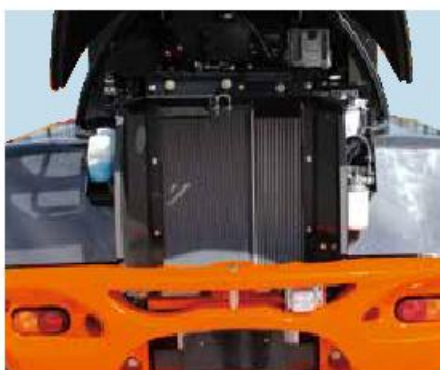
ラジエータとオイルクーラがサイドバイサイド配置で清掃が容易です。
