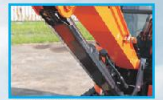
boomシリンダカバー 山形保護プレートにより、boomシリンダロッドを保護します。
